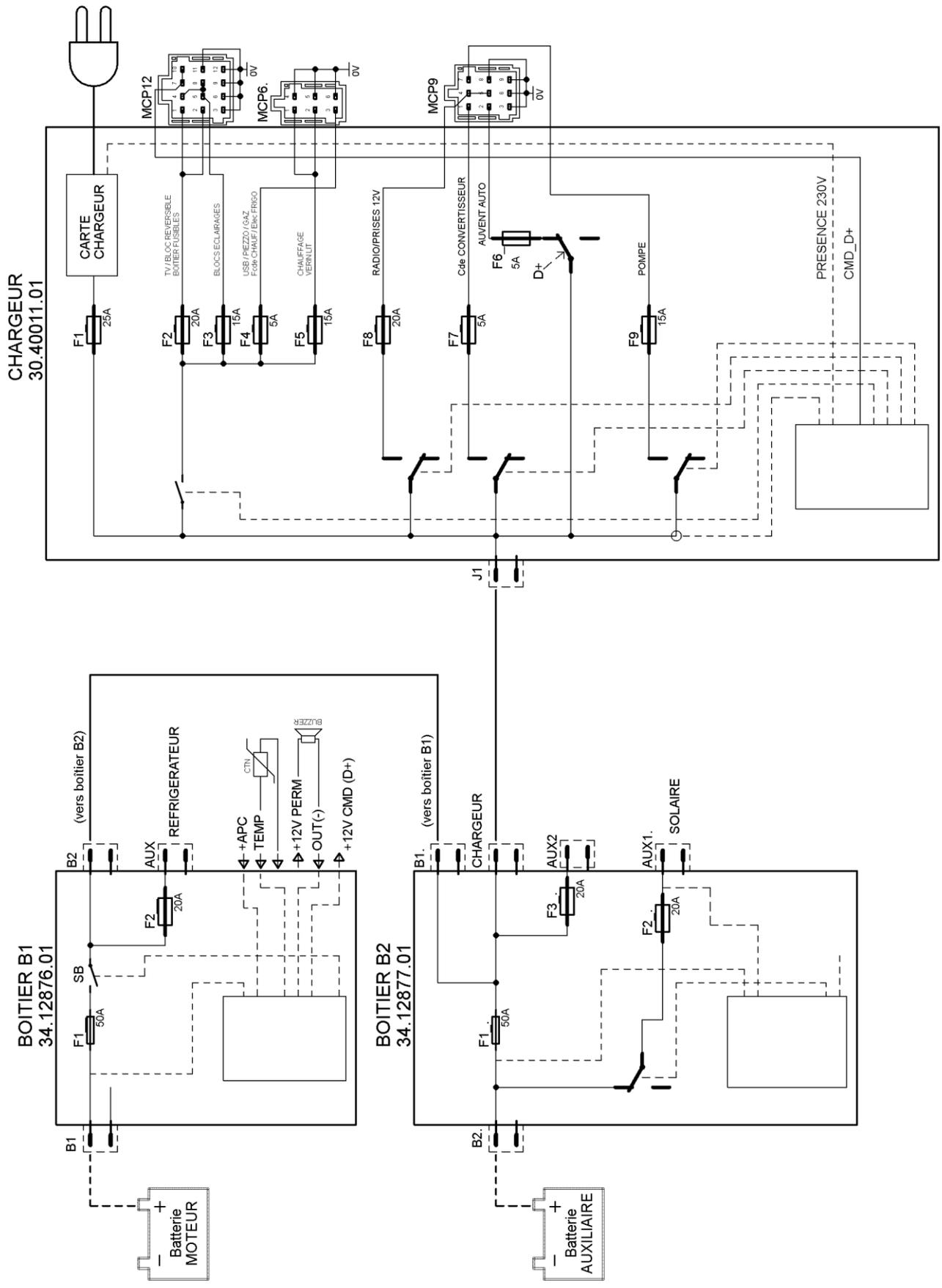
**RACCORDEMENT FAISCEAU CAN**
