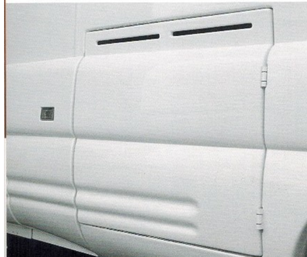
Trappe gaz, ouverture électrique ▼
