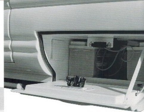
Coffre à batteries, ouverture électrique (2 x 110 A/h)
